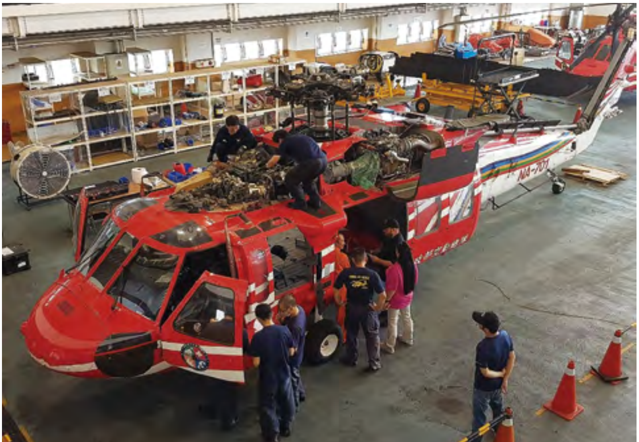
▲ 黑鷹機建立維護能量執行階段檢查（PMI）。
